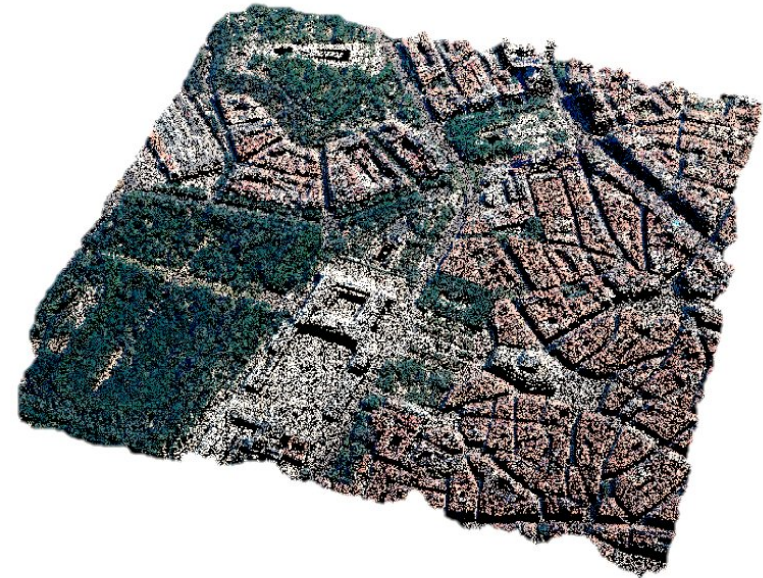
Se ha obtenido la cobertura arbórea utilizando la tecnología LiDAR. Imagen del Distrito Centro
